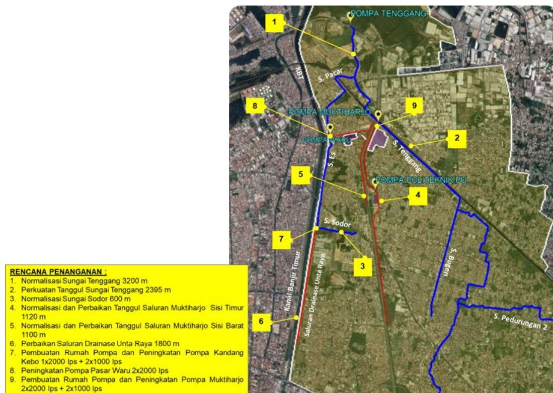
Gambar 2. Lokasi Penanganan Sub Sistem Tenggang
